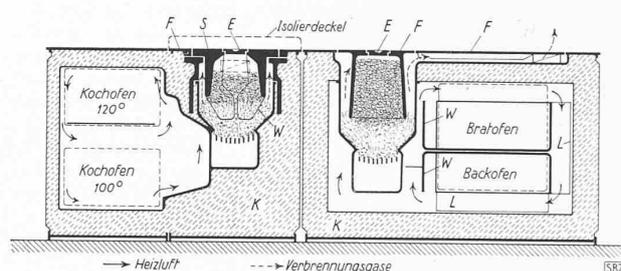
Abb. 22. Schematischer Schnitt 1:30 des AGA-Herdes
