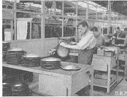
Abb. 3. Bearbeiten der Deckel für die Entwicklerkammern
