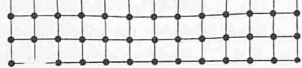
Abb. 15. Gitterstörung um ein Fremdatom in einem legierten Metall (das Fremdatom in der Mitte. Schemat. Darstellung)
