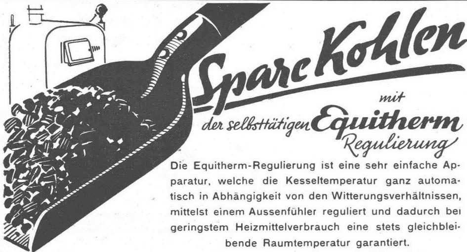
Die Equitherm-Regulierung ist eine sehr einfache Apparatur, welche die Kesseltemperatur ganz automatisch in Abhängigkeit von den Witterungsverhältnissen, mittelst einem Aussenfühler reguliert und dadurch bei geringstem Heizmittelverbrauch eine stets gleichbleibende Raumtemperatur garantiert.
