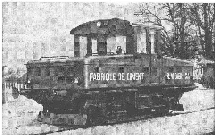
Elektrolokomotive mit Akkumulatoren-Batterie für Rangierdienst
