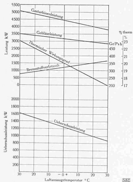
Abb. 13. Gasturbinenleistung und Brennstoffverbrauch in Funktion der Luftaussaugtemperatur
