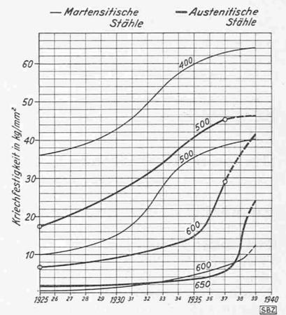
Abb. 12. Entwicklung dauerfester Stähle für Gasturbinen von 1925 bis 1940
