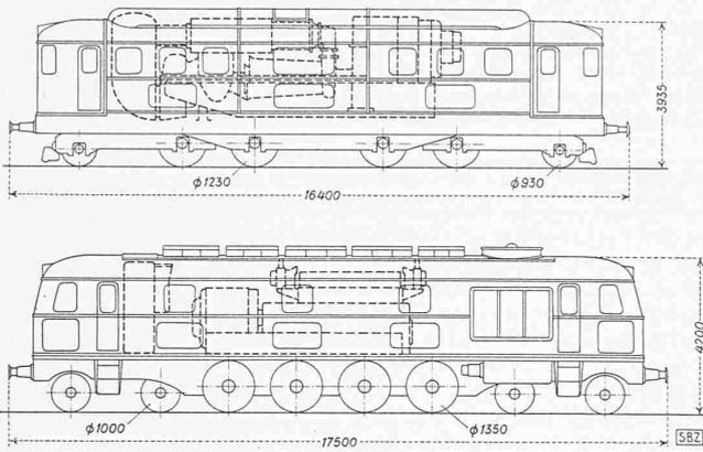
Abb. 11. Oben 2200 PS-Gasturbinen-Lokomotive Typ 1 A<sub>0</sub>-B<sub>0</sub>-A<sub>0</sub>1
