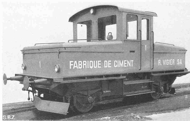
Abb. 1. Oerlikon-Akkumulatoren-Lokomotive von 100 PS
