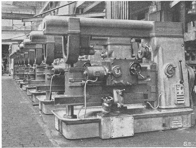
Abb. 6. Batterie von Starrdrehmaschinen nach Patent +GF+
