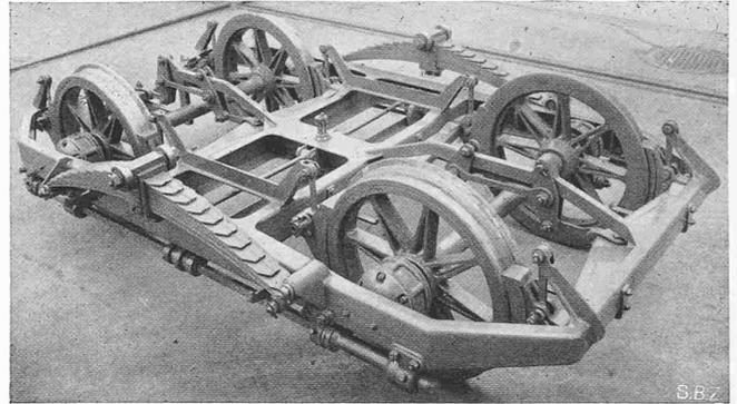
Abb. 5 und 6. Schmalspur-Drehgestell mit Pendelrahmen Patent SIG
