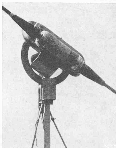
Abb. 6. Verbindung (mit Leitrollen) zwischen Seil und Gehänge
