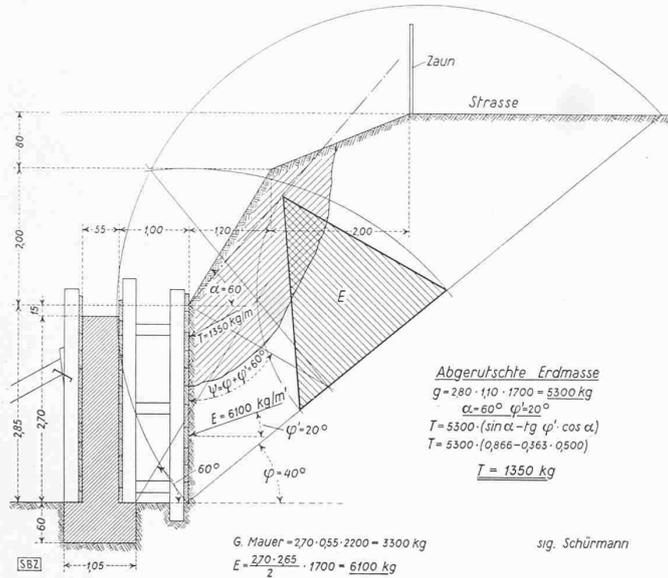
Abb. 3. Erddruckbestimmung des Gerichts-Experten Max Schürmann
