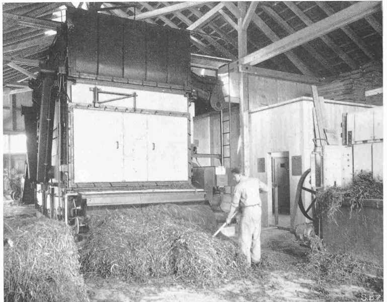
Abb. 3. Brown Boveri-Gastrockner mit Wärmerückgewinnung, Modell 1942 der Landwirtschaftl. Genossenschaft Kiesen. — Wasserverdampfung 800 kg/h entsprechend 200 bis 400 kg/h Trockengras, je nach Wassergehalt im Frischgras
