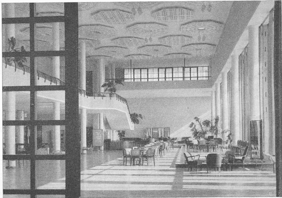
Abb. 26. Konzertfoyer, Blick nach Osten, links die Galerie vor den alten Tonhalle-Säulen, rechts Glaswand gegen den Gartenhof mit Ausblick auf See und Alpen. Typisch unstrukture Pfeiler ohne Basis und Kapitell, die gleitend durch die Decke durchzulaufen scheinen, nicht einzelne, körperlich in sich begrenzte «Säulen»; die Glaswand schwebt vor der Tragkonstruktion. An der Decke gemusterte Achtecktafeln, ausgehend von akustischen Notwendigkeiten, und von da ins Ornamentale entwickelt
