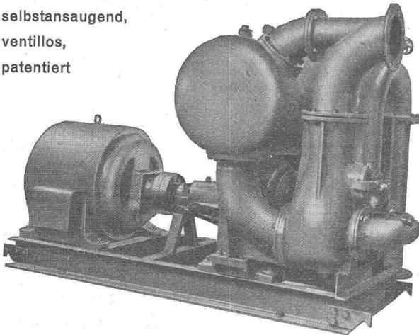
Saughöhen bis 9 m, Leistungen 1—500 Liter/Sek. **Kein Bodenventil** · **Keine Klappe im Saugstutzen** · **Keine Hilfs-Vakuumpumpe** · **Jederzeitiges automatisches Ansaugen** auch nach Lufteintritt im Saugrohr. Keine reibenden, sich abnützenden Flächen, daher unempfindlich gegen Sand, Schlamm und Kies.
