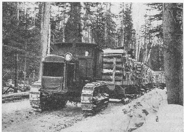
Abb. 5. Raupenschlepper mit Schlitten für Papierholztransport (U.S.A.)
