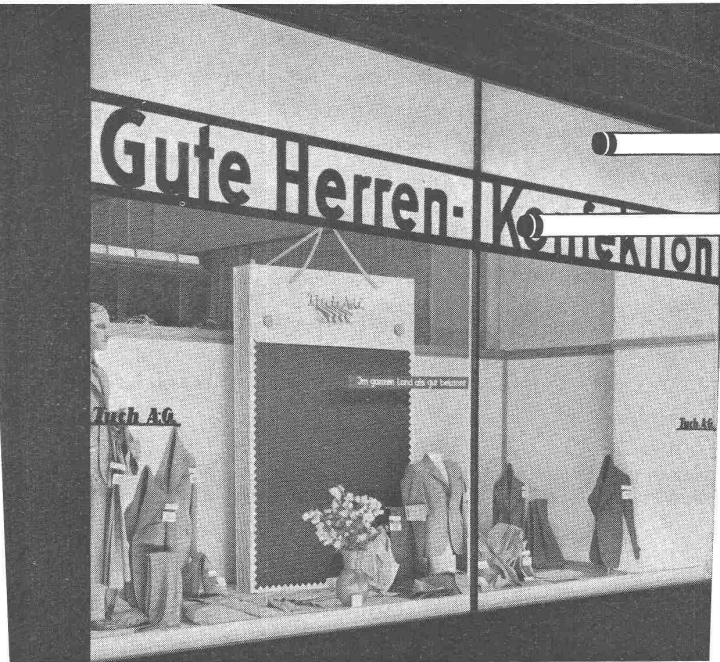
Schaufensterbeleuchtung mittels Leuchtstoffröhren
