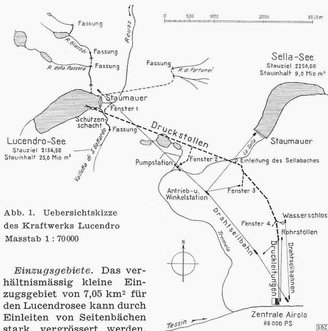
Abb. 1. Ubersichtsskizze des Kraftwerks Lucendro Masstab 1 : 70 000
