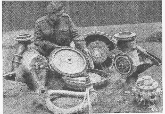
Abb. 8. Demontiertes Aggregat; das Turbinenlauftrad und die Segmente des Leitrades sind sichtbar. Im Vordergrund die mit Glaswolle isolierte Turbinenleitung und ein Sauerstoffverteiler
