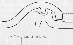
Abb. 11. Ludowici-Fachwerkdach. Die überdeckte, hochgestellte Fuge bleibt bis zu einem starken Rückschwall-Wasserstand trocken
