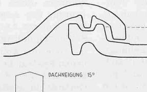
Abb. 11. Ludowici-Flachpfannendach. Die überdeckte, hochgestellte Fuge bleibt bis zu einem starken Rückschwall-Wasserstand trocken
