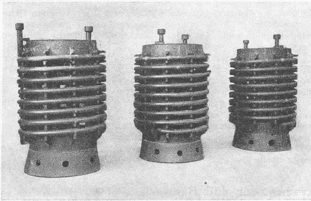
Abb. 1. Kühlschlangen. Rohr aus bildsamer Siliziummasse, auf den Träger aufgewunden und mit diesem zusammen gebrannt
