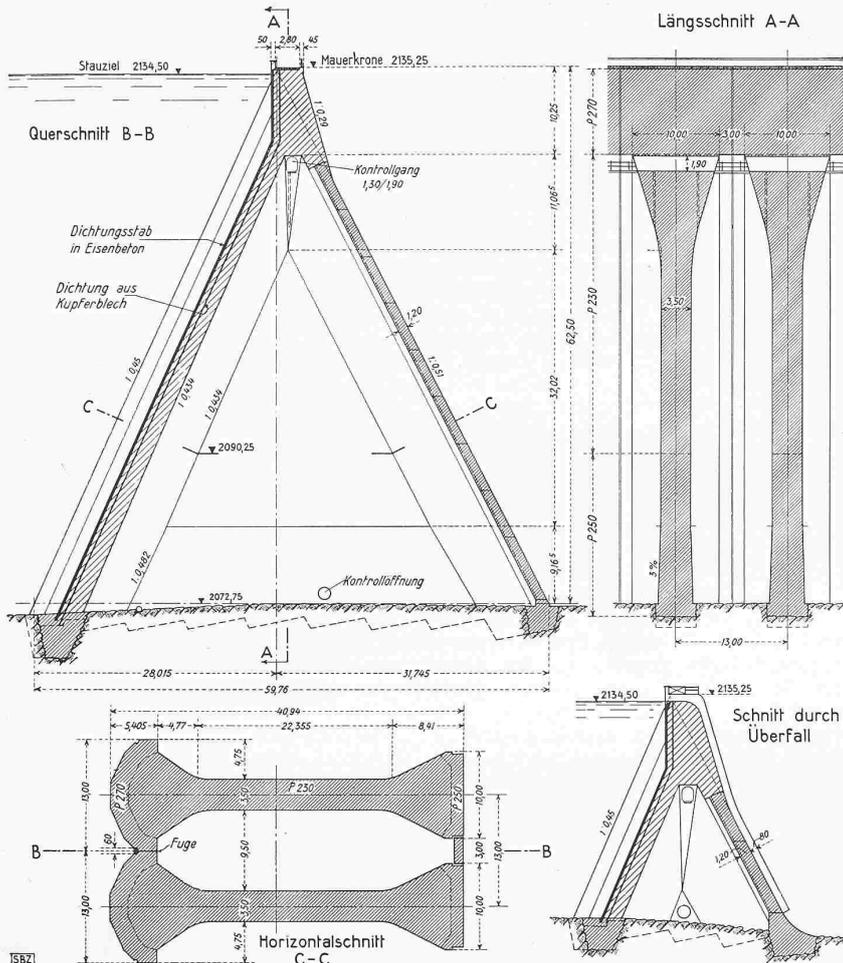
Abb. 3. Einzelheiten der Staumauer Lucendro. — Masstab 1 : 800
