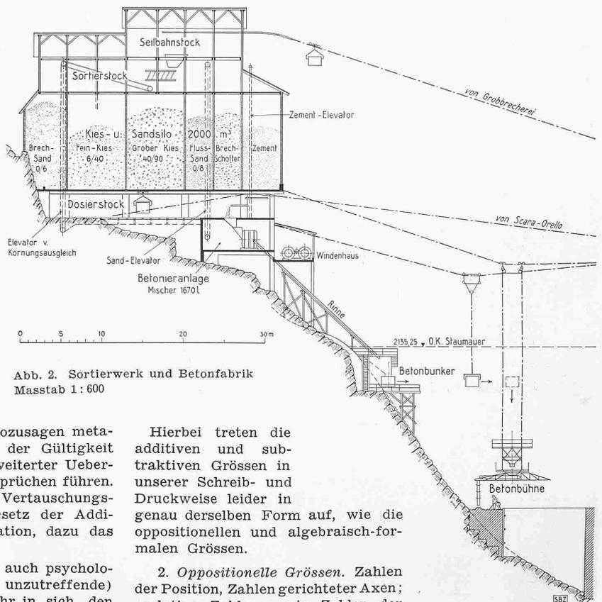
Abb. 2. Sortierwerk und Betonfabrik Masstab 1:600
