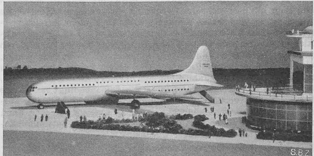
Abb. 9. Modell des Consolidated-Vultee 37, der das grösste Flugzeug der Welt darstellen wird. Sechs Motoren zu je 5000 PS Startleistung, 204 Passagiere
