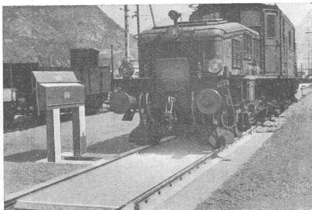
Kein Unterhalt der Brücke, wassergeschütztes Unterwerk
