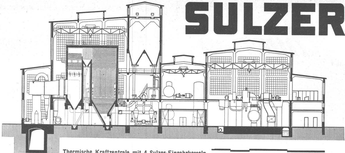
Thermische Kraftzentrale mit 4 Sulzer-Einrohrkesseln
