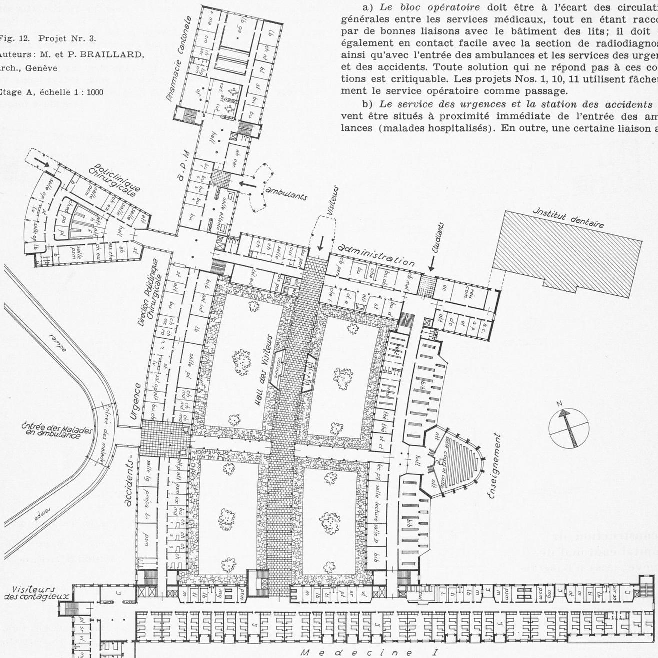
a) Le bloc opératoire doit être à l'écart des circulations générales entre les services médicaux, tout en étant raccordé par de bonnes liaisons avec le bâtiment des lits; il doit être également en contact facile avec la section de radiodiagnostic, ainsi qu'avec l'entrée des ambulances et les services des urgences et des accidents. Toute solution qui ne répond pas à ces conditions est critiquable. Les projets Nos. 1, 10, 11 utilisent fâcheusement le service opératoire comme passage.
