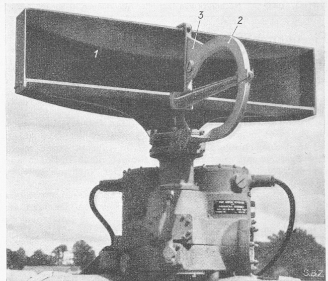
Bild 1. Antenne mit rotierendem «Kässchnitten»-Reflektor. 1 Reflektor, 2 Wellenleiter, 3 Trichter zum Einstrahlen der elektrischen Wellen in den Reflektor
