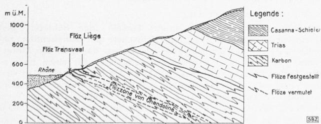
Bild 3. Schematisches Profil durch das Grubengebiet bei Chandoline
