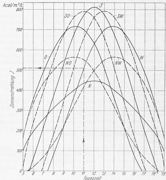
Bild 7. Tagesverlauf der Sonnenstrahlung J bei wolkenlosem Himmel in kcal/m²h auf verschieden orientierte Dächer mit 30^\circ Neigung am 1. Juli an Orten auf 50^\circ nördlicher Breite (Arbeitsblatt 63, Heizung und Lüftung, Heft 9, September 1942)
