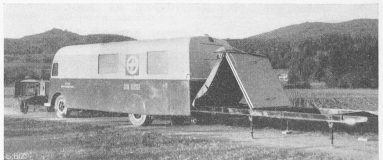
Bild 1. Der Boden des Auskleideraums wird abgeklappt
