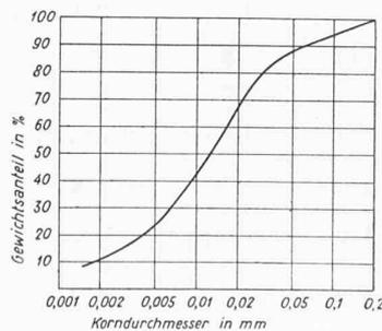
Bild 13. Summation der Kornverteilung des verwendeten Quarzmehls
