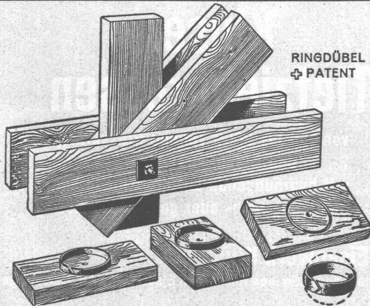
Knotenpunktverbindung für hölzerne Tragwerke
