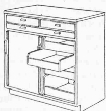
Bild 30. Rüsttisch-Einheit HSB-BORO. Links feste Tablare, rechts Ausziehfücher. Unter den oberen Schubladen Ausziehbrett. Masse: Länge 75, 90, 105, 120 cm; Höhe 80 u. 90 cm; Tiefe 57 cm
