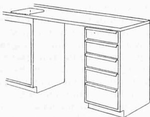
Bild 31. Rüsttisch-Schränkeinheit für Arbeitsgeräte neben dem Arbeitsplatz der Küche Bild 4. Masse: 40 × 85 × 60 cm
