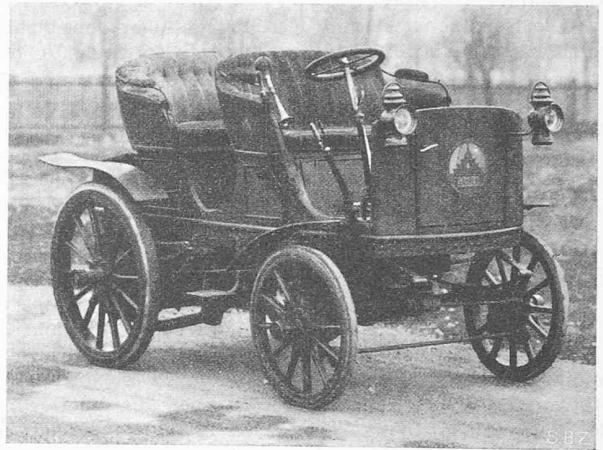
Bild 10. Das erste Saurer Personenautomobil (1896). Im Heck eingebauter Motor mit Einspritzung von Benzin oder Petrol
