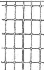
**Drahtziegelgewebe und Streckrabitz** die beiden bevorzugten Putzmörtelträger
