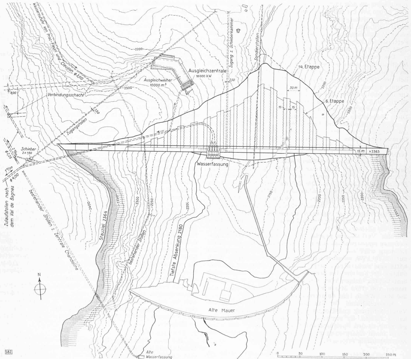
Bild 1. Kraftwerk Gross-Dixence, Grundriss der Sperrstelle, Masstab 1:5000
