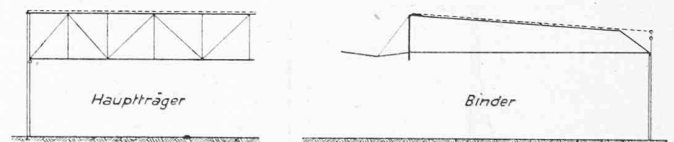
Bild 22. Auflagerung der Träger und des Windverbandes, Werfthalle Kloten
