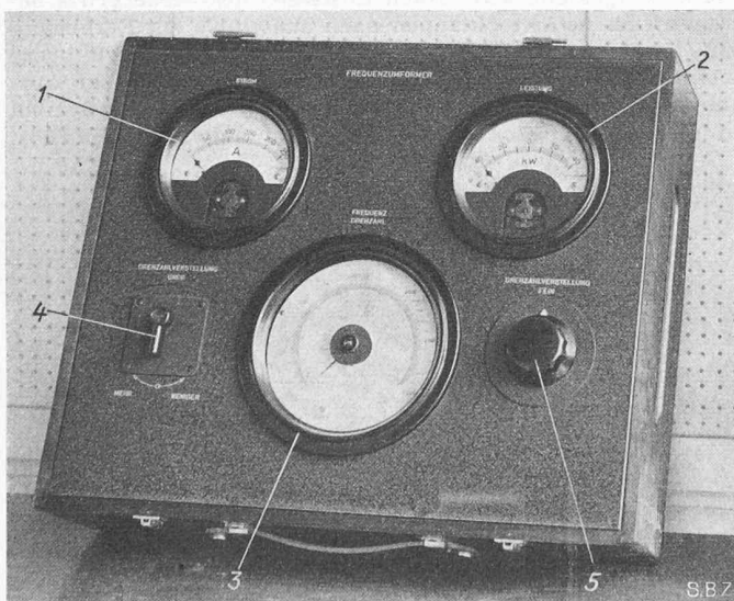
Bild 21. Tragbarer Steuerkasten für die Propellermotoren (Bild 26, Seite 568). 1 Ampèremeter der Propellermotoren, 2 Wattmeter der Propellermotoren, 3 Tachometer, 4 Drehzahlinsteller grob, 5 Drehzahlinsteller fein
