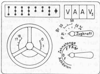
Bild 24. Führerstand-Steuertisch der Fhe 4/6-Gepäcktriebwagen, Serie 901, der SBB.
