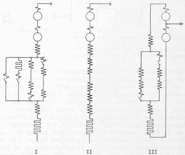
Bild 21. Schaltung der Triebmotoren der BCFhe 4/4-Triebwagen, Serie 1, der Elektrischen Bahn St. Gallen-Gais-Appenzel.
