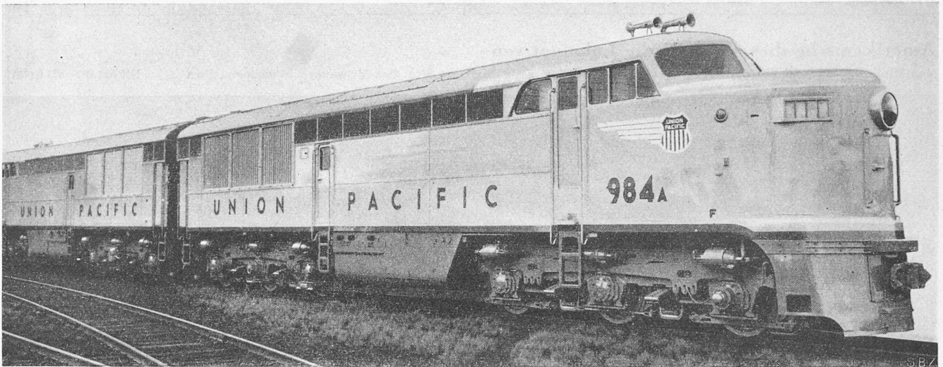
Bild 2. Diesel-elektrische Schnellzuglokomotive der Fairbanks Morse Co., bestehend aus zwei Einheiten von je 2000 PS
