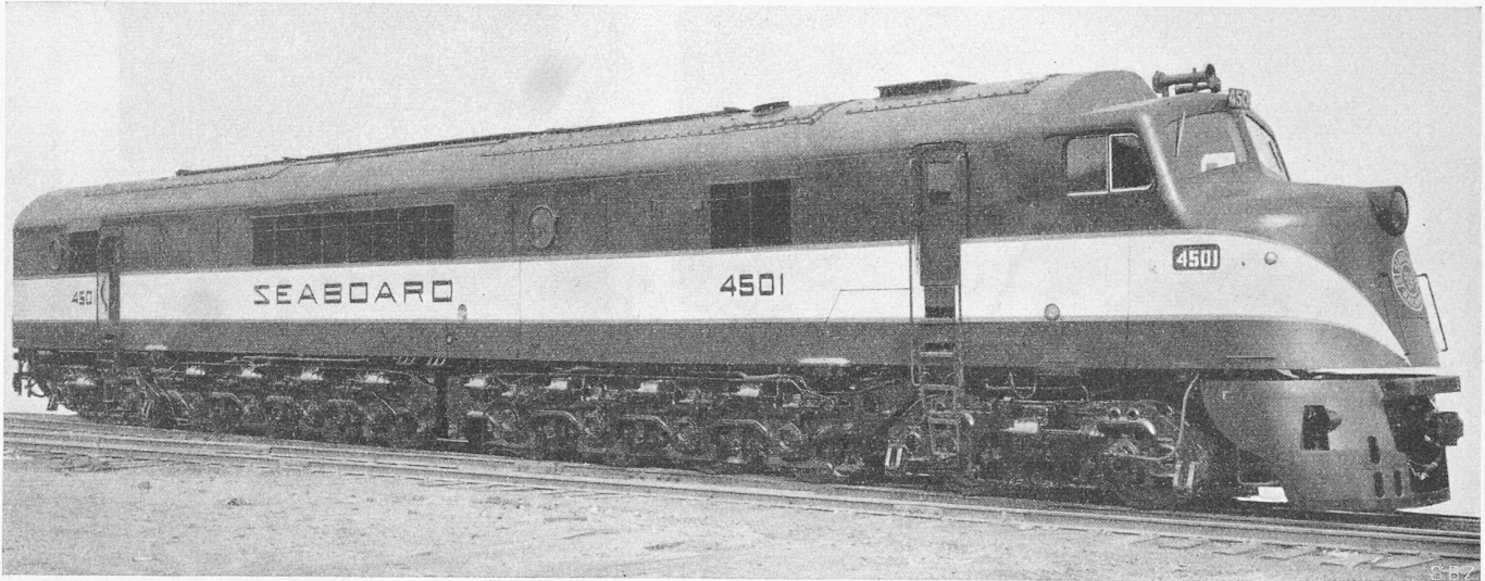
Bild 3. Diesel-elektrische Lokomotive der Baldwin Locomotive Works, Achsfolge 2 D 0 - D 0 2 von 3000 PS
