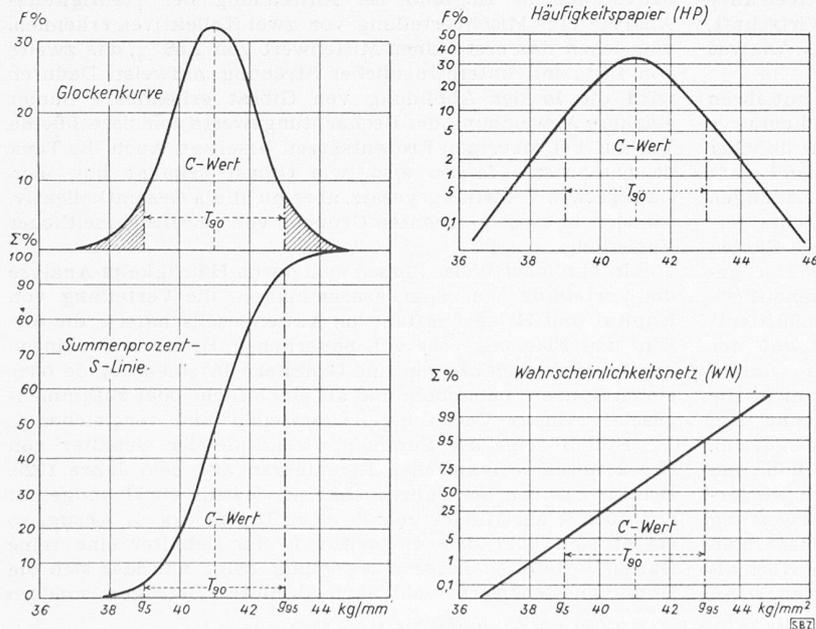
Bild 1. Verschiedene Darstellungen einer Normalverteilung (Festigkeiten einer Stahlsorte)
