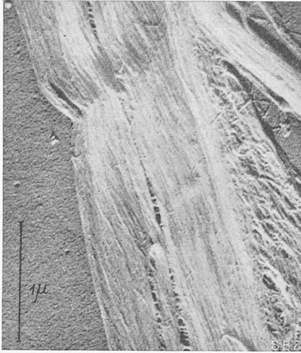
Bild 1. Baumwollfaser Paralleltextur der Sekundärwand
