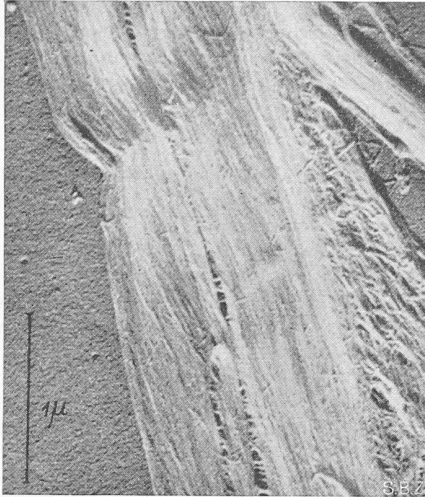
Bild 1. Baumwollfaser Paralleltextur der Sekundärwand
