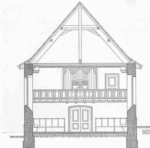
Bild 2. Renoviertes Kirchlein Fluntern, Querschnitt 1:200
