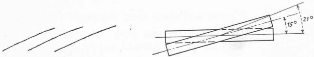
Bild 20. Drei Aufnahmen der Schwingungsrichtung am Schaufelkopf für das Seitenverhältnis 10/1 und 15° Verdrillung. Die Schwingungsrichtung ist gegen die 2. Hauptträgheitsaxe des Fussquerschnittes und damit gegen die Erregungsrichtung um 21° verschoben.
