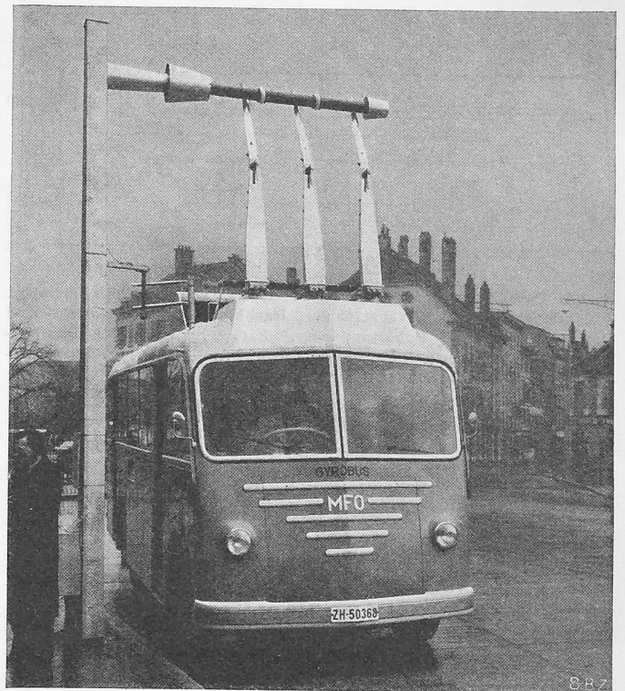
Bild 10. Gyrobus an der Energietanksäule
