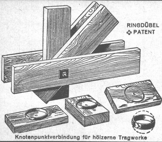
Knotenpunktverbindung für hölzerne Tragwerke
