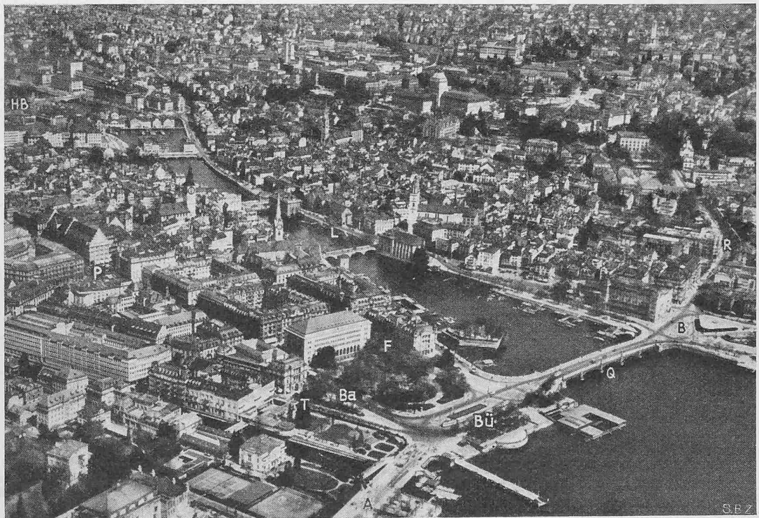
Bild 2. Bürkliplatz, bauliche Gestalt und heutige Verkehrsführung; Masstab 1:2000. Links das westliche Platzende, wo der Verkehr durch Lichtsignale geregelt ist. Rechts der Brückenkopf der Quaibrücke, wo sich der starke Linksabbiegeverkehr vom Alpenquai nach der Innenstadt völlig unbeaufsichtigt und unregelmäßig mit den Fahrbewegungen der Strassenbahn und des Verkehrs zwischen Bellevueplatz und linkem Limmatufer auseinandersetzen hat
