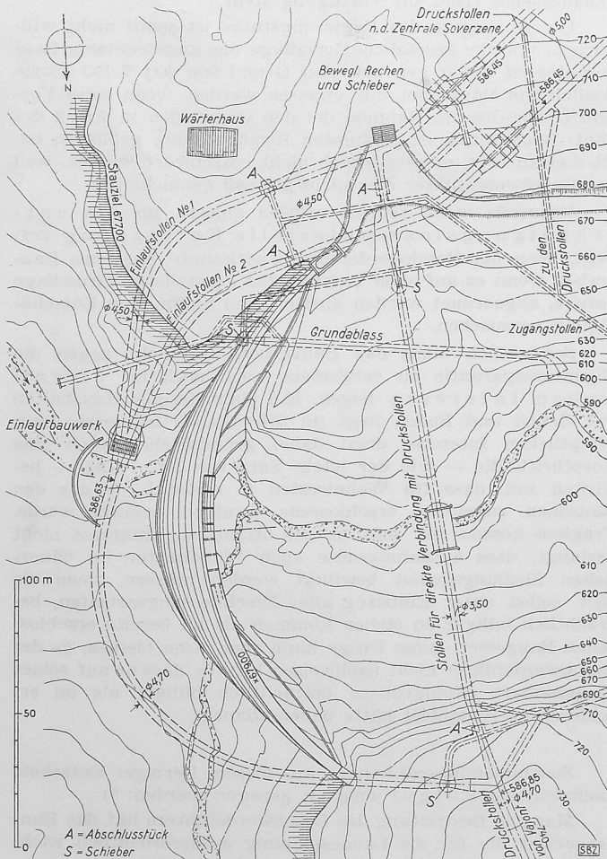
Bild 20. Staumauer Val Gallina, Lageplan, Masstab 1:2500
