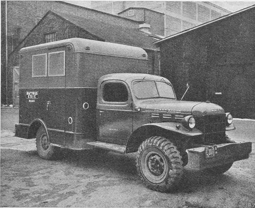
Bild 15. Lastwagen mit eingebauter Instrumenten-Anlage
