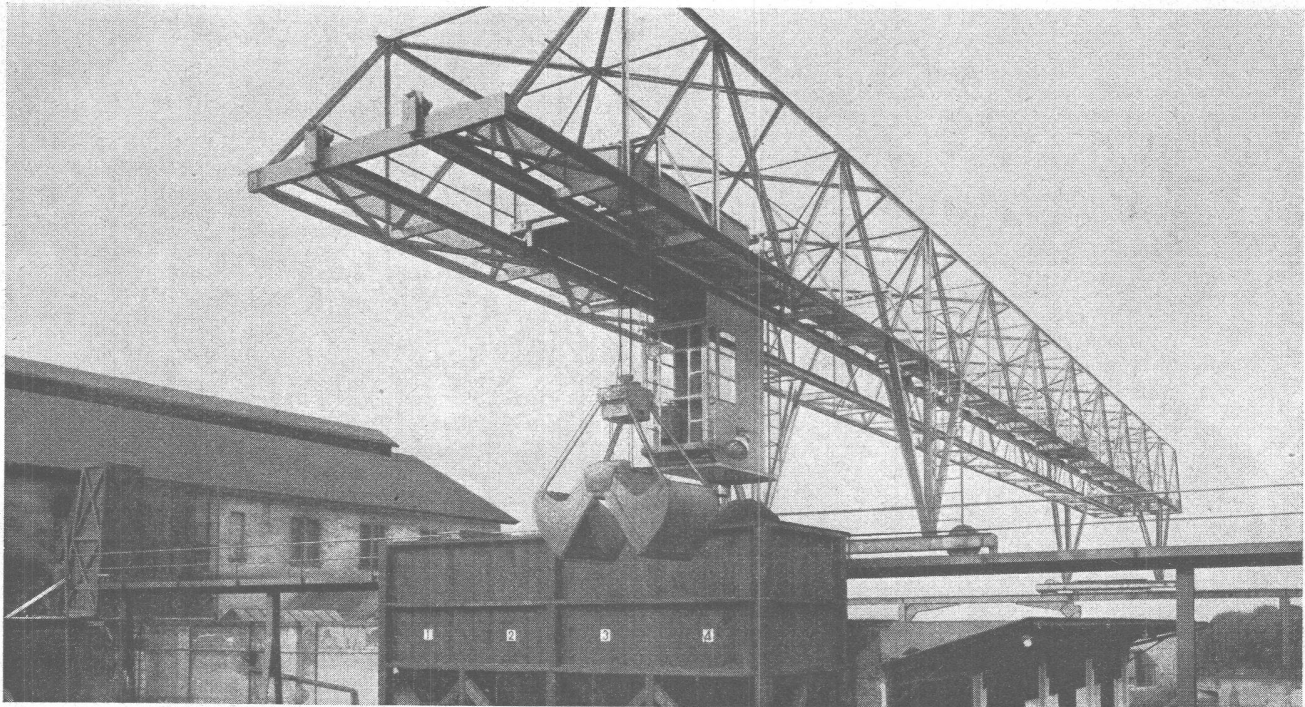
Verladebrücke in Schweisskonstruktion 2,5 t Tragkraft, 46 m Länge
