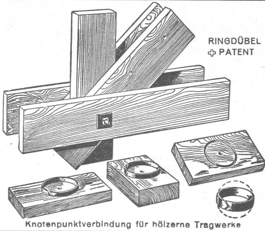
Knotenpunktverbindung für hölzerne Tragwerke
